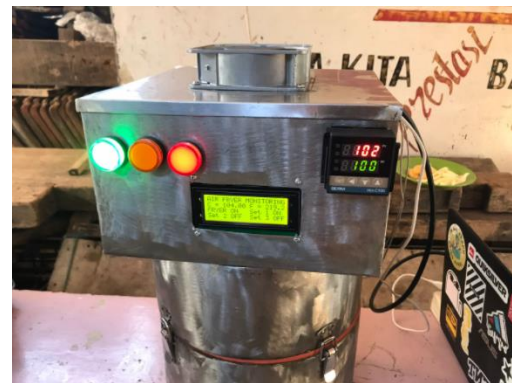
Gambar 2 Konstruksi air fryer
