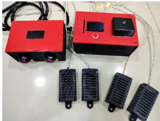
Gambar 7 Hasil Proses Perakitan Akhir Alat Otomasi Kendali AC
