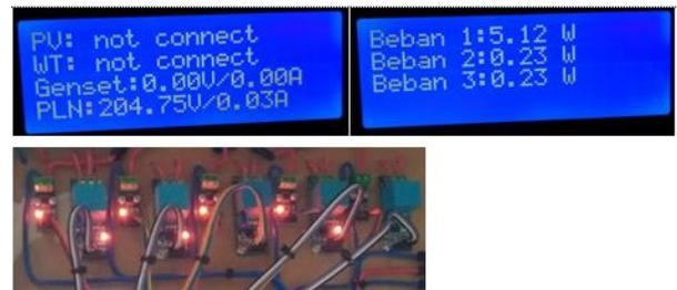
Gambar 1 : Pengujian Sensor Arus ACS 712 Dan Sensor Tegangan ZMPT 101b
