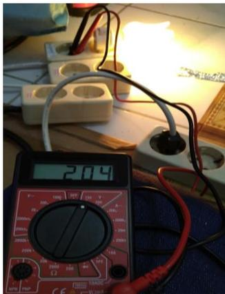
Gambar 2 : Pembacaan Nilai Tegangan dengan Menggunakan AVO Meter
