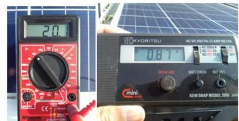
Gambar 4 : Pembacaan Nilai Tegangan dan Arus dengan Menggunakan Avo Meter, Tang Amper serta LCD
