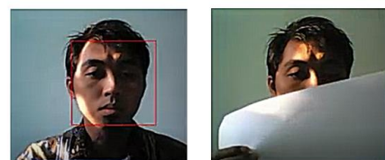
Gambar 5. Pengujian ketahanan dengan oklusi dengan metode viola jones
