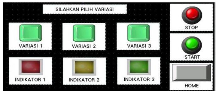
Gambar 2 Tampilan modul HMI pada pengupas kelapa muda
