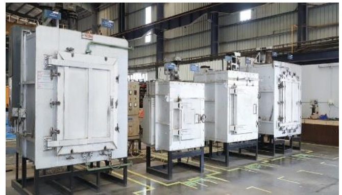
Gambar 1. Tungku untuk Proses Pembakaran
