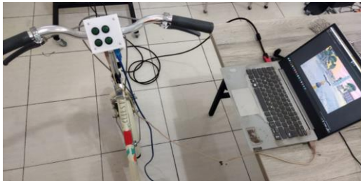
Gambar 20. Pengujian hardware melakukan koneksi hardware dan software , kalibrasi, dan pengendalian game .
