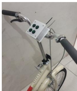
Gambar 12. Hardware yang Terpasang pada Sepeda
