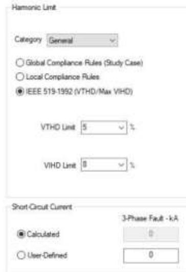
**Gambar 8.** Batas Harmonisa pada Bus Crane RTG
