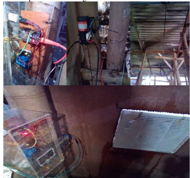
Gambar 6. Bentuk fisik alat monitoring suhu dan kelembaban
