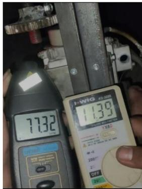
Gambar 16. Hasil rpm dan volt yang dikeluarkan turbin.
