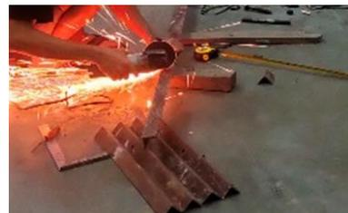
Gambar 5. Membuat rangka bawah turbin.
