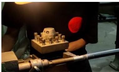
Gambar 6. Pembubutan poros turbin
