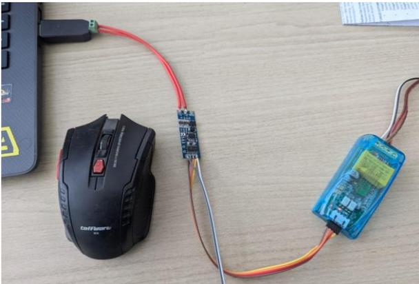
Gambar 5 Setting Perangkat Keras Pengubah ID Sensor
