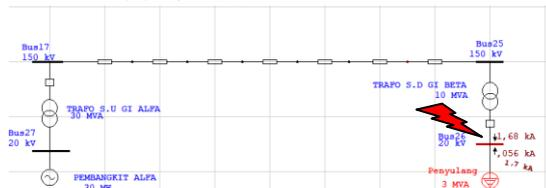
**Gambar 4. Titik gangguan 3 phase pada Busbar 20 kv**
