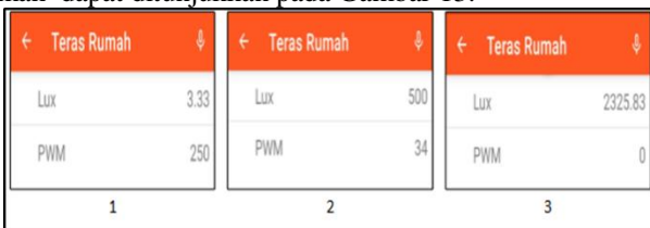
Gambar 13. Hasil Pembacaan Lux Dan PWM Lampu Aplikasi Openhabian
