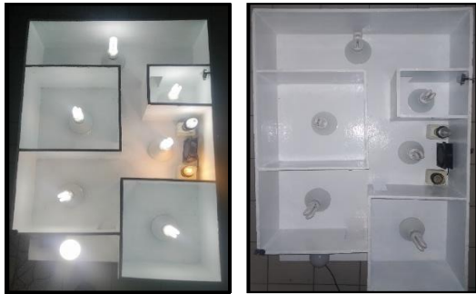
Gambar 5. Hasil Respon Switch ON Dan Switch OFF Pada Beban Listrik
