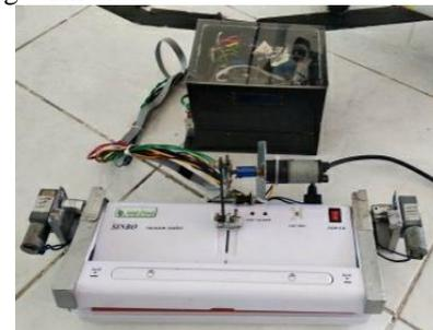
Gambar 4 Bentuk Fisik Mesin Pres *Vacuum Sealer*
