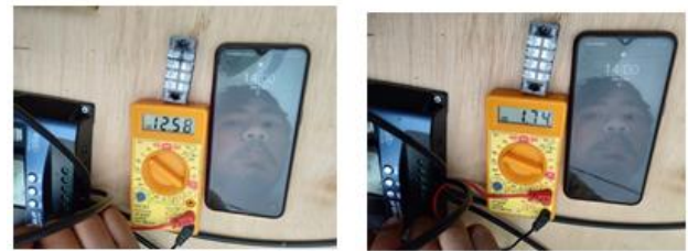
Gambar 13. Sebelah kiri menunjukkan pengukuran tegangan tertinggi, sebelah kanan menunjukkan pengukuran arus tertinggi
