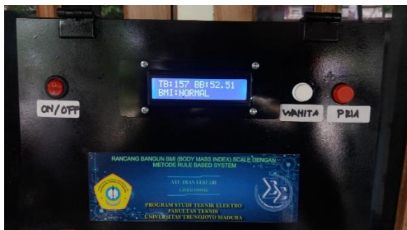
Gambar 3.5 Sampel Data Hasil Uji Alat Dengan Objek Perempuan
