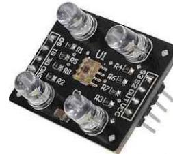
Gambar 7. Sensor Warna TCS3200
