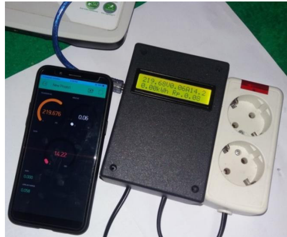
Gambar 6 Alat Pembaca kWh Meter
