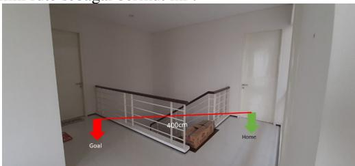
Gambar 21 Rute robot untuk pengujian jarak 400cm
