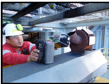
Gambar 8. Pengujian dan Perbandingan Pembacaan dengan Portable Gas Detector
