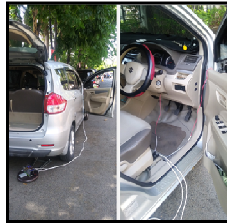
Gambar 9. Alat Rancangan dihubungkan ke Sistem Kelistrikan Mobil dan Sensor alat rancangan diberi paparan gas buang
