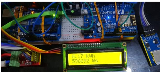
Gambar 8 Display Data Akumulasi pada LCD 16x2
