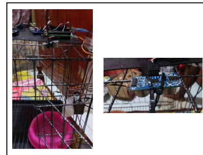
Gambar 13. Penempatan Sensor Ultrasonik Kandang (kiri) tampak depan (kanan) tampak atas
