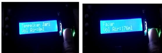
Gambar 13. Proses Pengujian Pembacaan nilai *Volume* air
