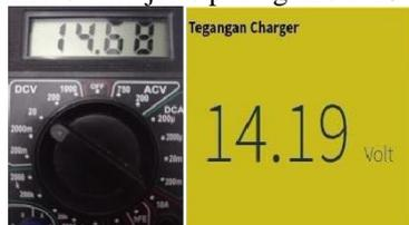
Gambar 18. Pengujian Sensor Tegangan DC Pada Charger
