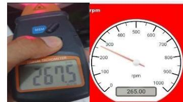
Gambar 20. Pengujian Sensor IR RPM
