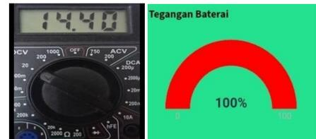
Gambar 19. Pengujian Sensor Tegangan DC
