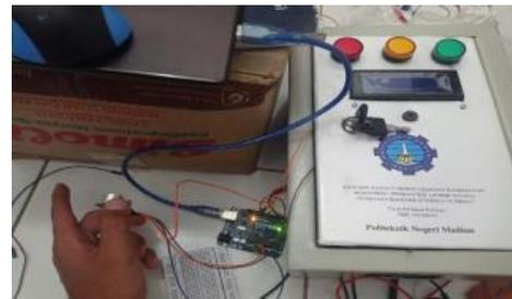
Gambar 14. Alat Sistem Charging dan Monitoring Baterai pada PLTPH
