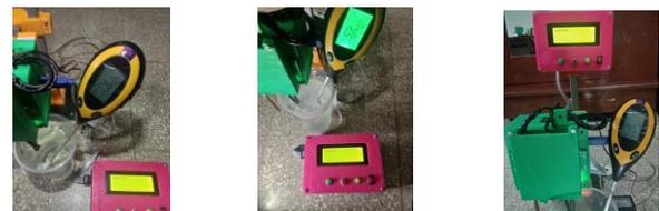
Gambar 11. Perbandingan sensor suhu DS18B20 dengan 4In 1 Soil Survey pada air mineral, air dingin dan air panas
