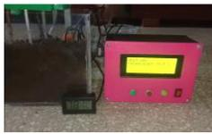
Gambar 8. Perbandingan Sensor Soil Moisture dengan Hygrometer Digital
