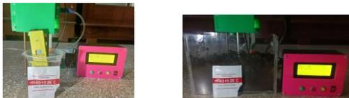
Gambar 9. Perbandingan Sensor pH dengan pH meter pada Buffer 4.01 dan tanah yang disiram Buffer 4.01
