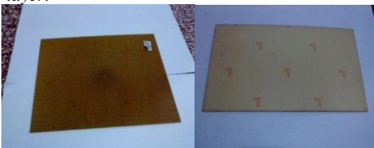
Gambar 2. PCB dengan jenis bahan pertinak, dan fiber.
