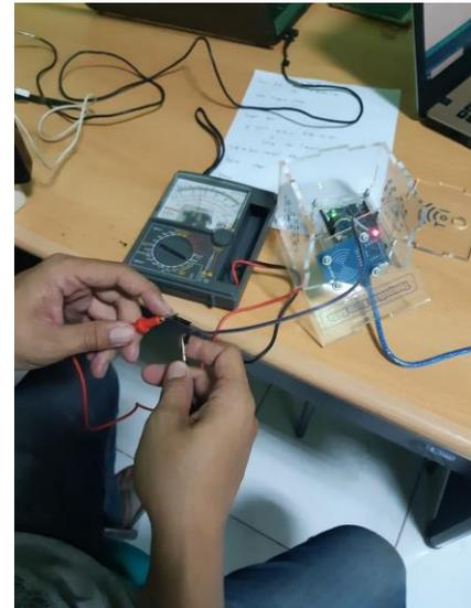
Gambar 7 Pengukuran Tegangan Arduino dan RFID-RC522
