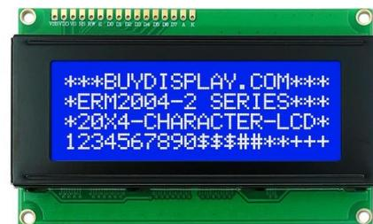
Gambar 4. Modul LCD 20x4.
