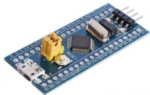
Gambar 1. Mikrokontroler STM32F103
