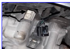
Gambar 8. Membuka konektor sensor
