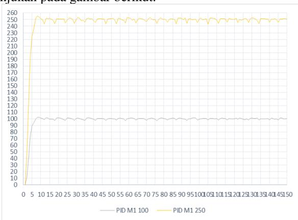
Gambar 6 Kurva PID Motor 1 Pada Setpoint 100 rpm dan 250 rpm
