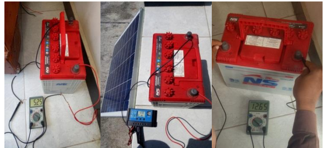
Gambar 13. Sebelum saat dan sesudah di charge (Panel Surya)
