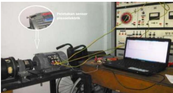
Gambar 1. Proses pengambilan data getaran motor
