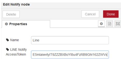
Gambar 6 Konfigurasi *node* Line
