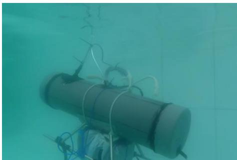
Gambar 5. ROV mempertahankan kedalaman
