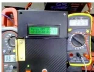
Gambar 7. Pengujian arus dengan modul power switch
