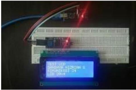
Gambar 10. Rangkaian LCD I2C
