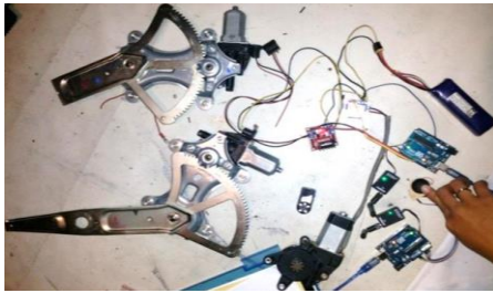
Gambar 3.3 percobaan untuk menggerakkan motor pada Azimut, elevasi dan picu dengan joystick.
