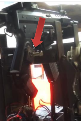
Gambar 3.10 Senjata pada saat menembak motor picu bergerak ditunjukkan oleh panah
