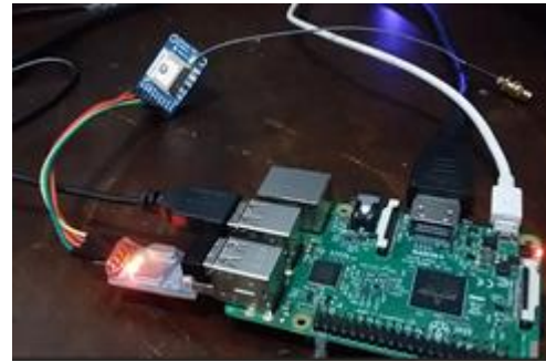
Gambar 9. Rangkaian pengujian sensor GPS.
