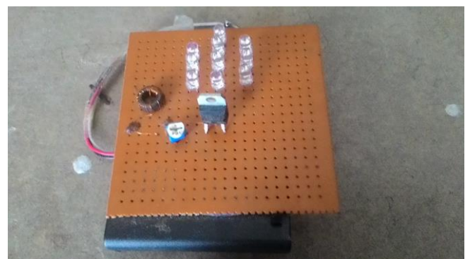
Gambar 7. Lampu penerangan joule thief
