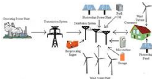
Gambar 3. Distributed Generation Pada Jaringan Distribusi
