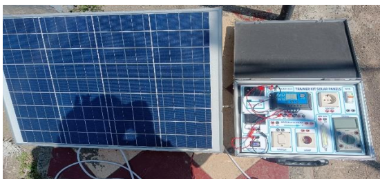
Gambar 5. Pengujian Pengisian Batrai
