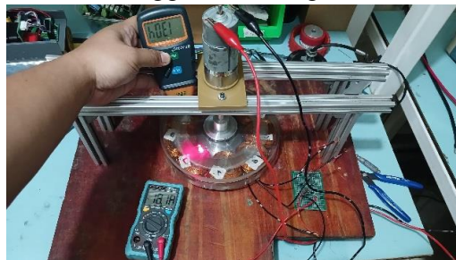
Gambar 4. Pengujian Generator Tanpa Beban
