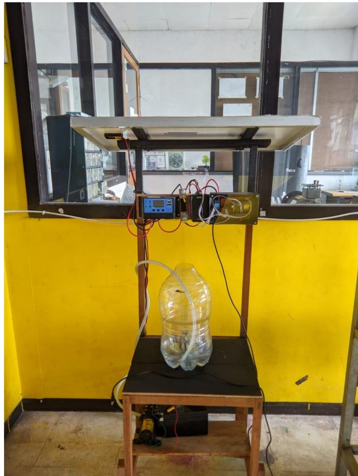
Gambar 3. Prototipe Sistem *Monitoring* PLTS dan Kontrol Pompa Air Berbasis IoT
