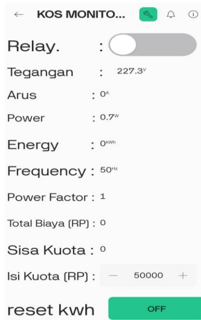
Gambar 5. Tampilan Aplikasi Saat Relay OFF
