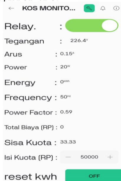
Gambar 6. Tampilan Aplikasi Saat Relay ON
