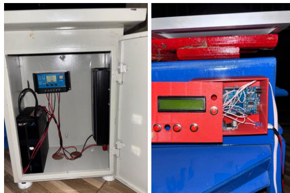
Gambar 6 Hasil Proses Perakitan Sistem Rangkaian Elektronika Alat
