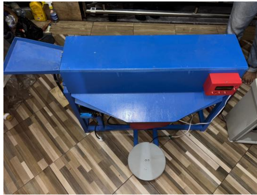
Gambar 5 Hasil Proses Perakitan Rangka Mesin Perontok Jagung
