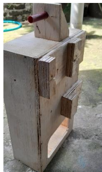
Gambar 5 Hasil Proses Perakitan Rangka Penggulung Spul Otomatis
