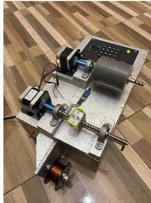
Gambar 7 Hasil Proses Perakaitan Akhir Alat Gulung Spul Otomatis
