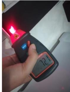
Gambar 7. Hasil Pengujian RPM Konveyor
