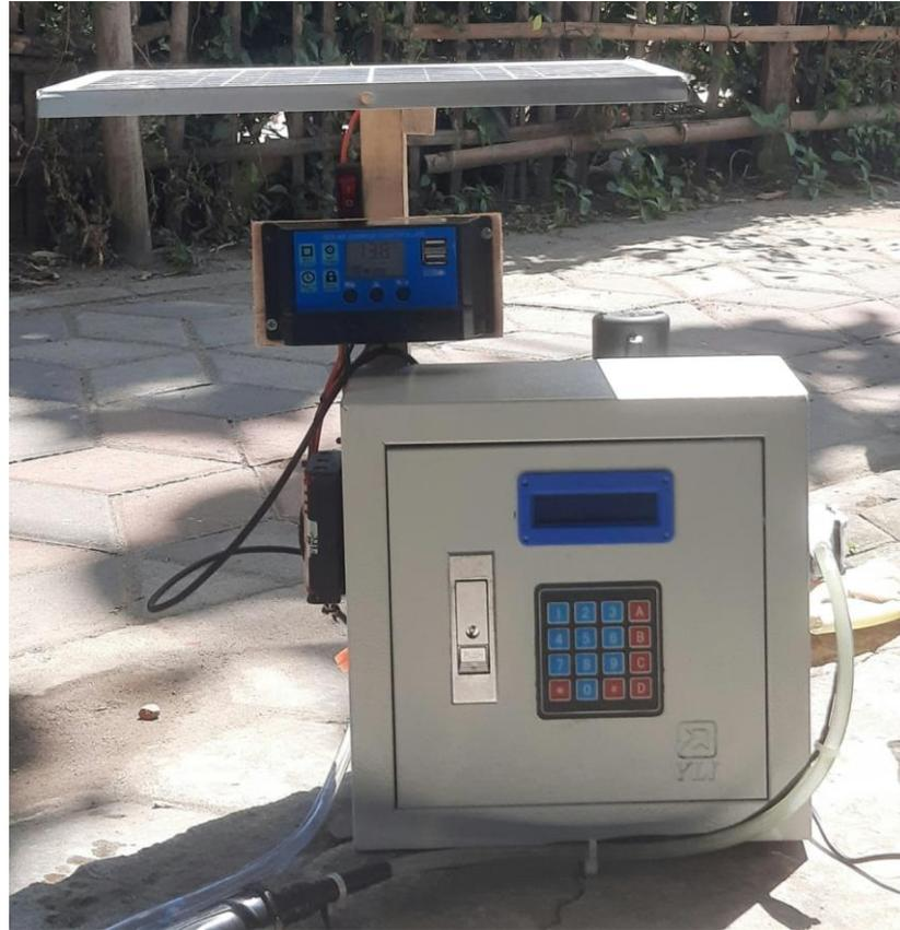
Gambar 5. Hasil Perancangan Alat Pompa Elektrik Oli
