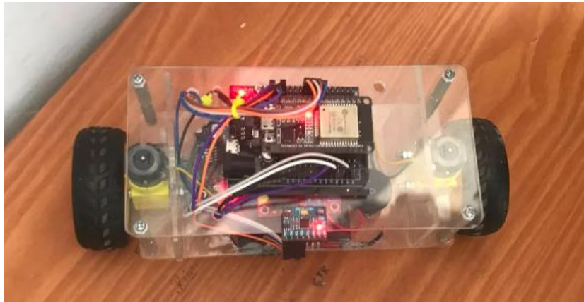
Gambar 5. Dokumentasi Fisik Kestabilan Berdiri Tegak Robot Self-Balancing Menggunakan Metode DMP MPU6050.
