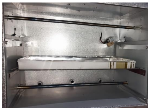
Gambar 6 Pemasangan Sensor Suhu DHT22 dan Elemen Pemanas Tubular
